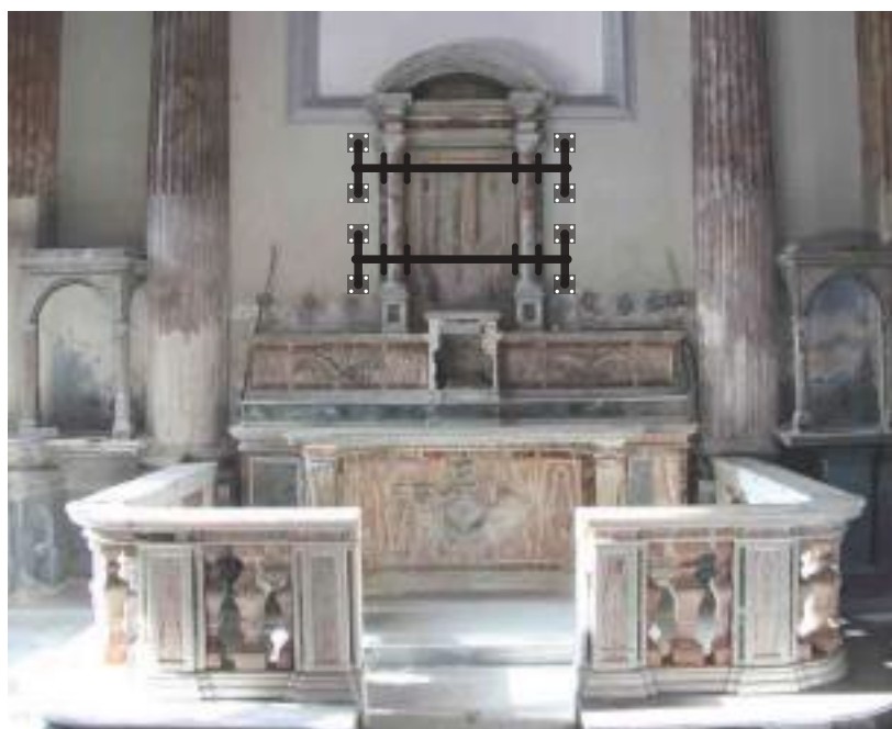
Schema di puntellatura da eseguire durante la fase di smontaggio degli altari centrali
